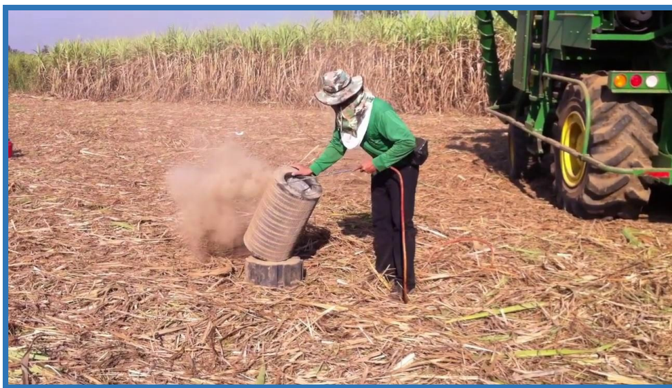
รูปที่ 3.4 การเป่ากรองอากาศแบบแห้ง
