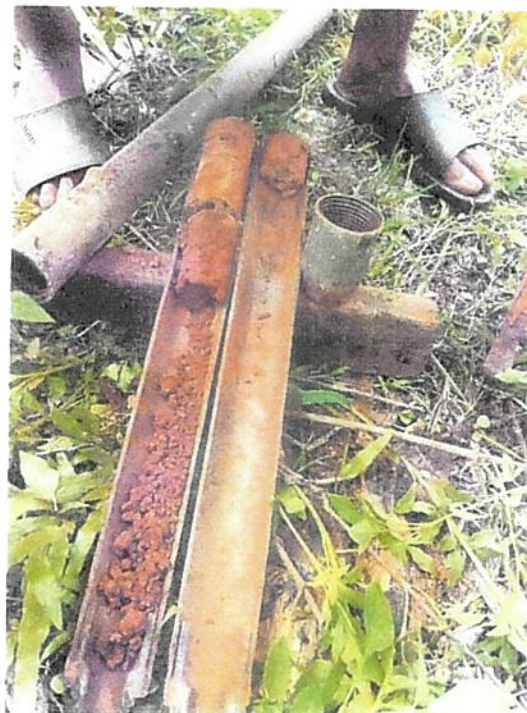
ภาพแสดง การเจาะสำรวจชั้นดิน หลุมเจาะ BH-1
