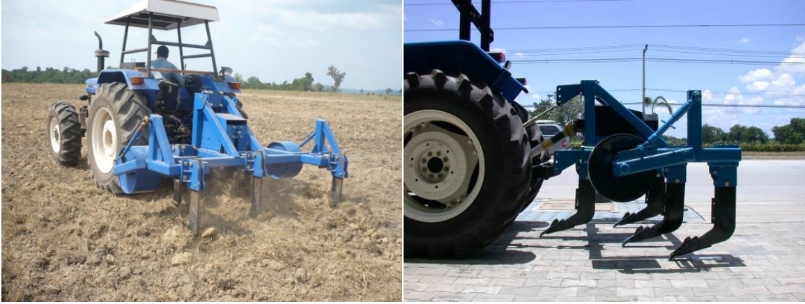
ภาพที่ 3 การใช้ไถดินดาน 5 ขา ชนิดที่มีระบบสั่นสะเทือน
