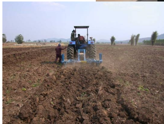
ภาพที่ 9 ไถระเบิดดินดานชนิดสั้น (Shakearator)
